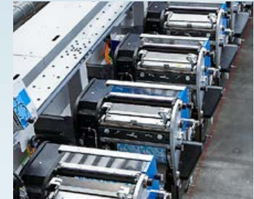
Ein extrem kurzer Bahnlauf reduziert die Makulatur.
