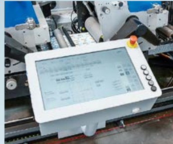
Intuitives Bedienpanel mit Touchscreen-Steuerung.
